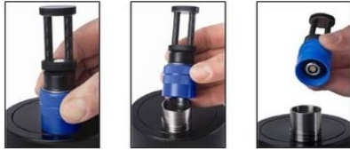
Xchange sensörlerinin sökölüp takılması
